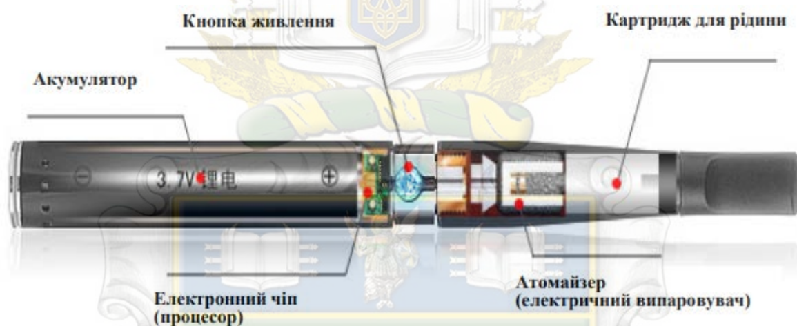
Рисунок 2.1 – Структура електронної сигарети
