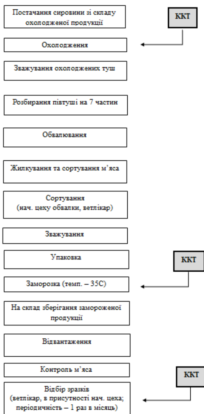
Рис. 2. Технологічна схема виробництва м'ясної продукції та визначення контрольно-критичних точок технологічного процесу
