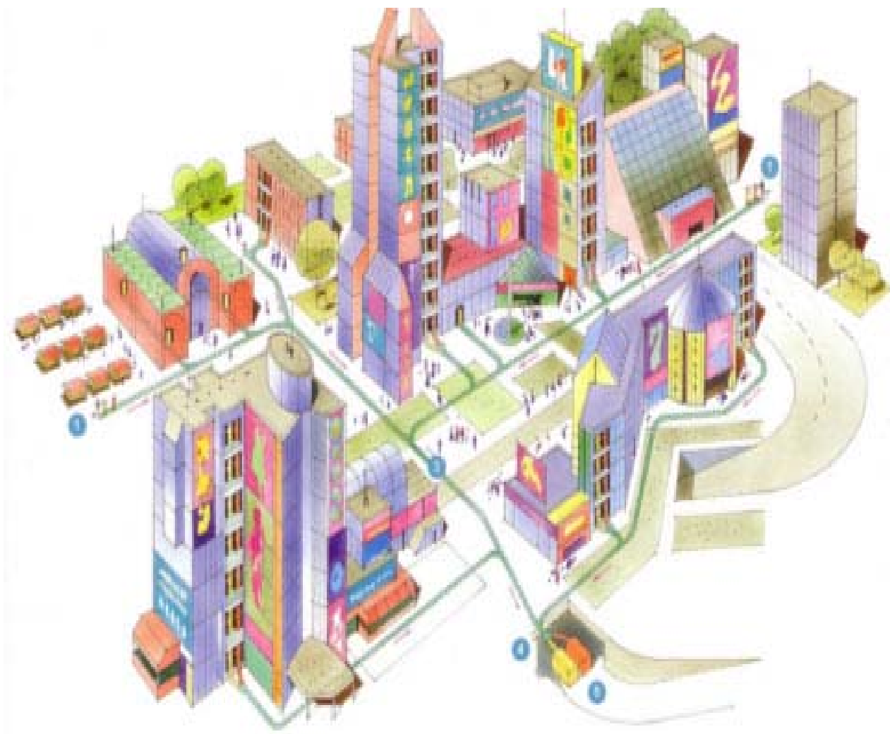
Рисунок 7 – Пневматична система транспортування біовідходів
