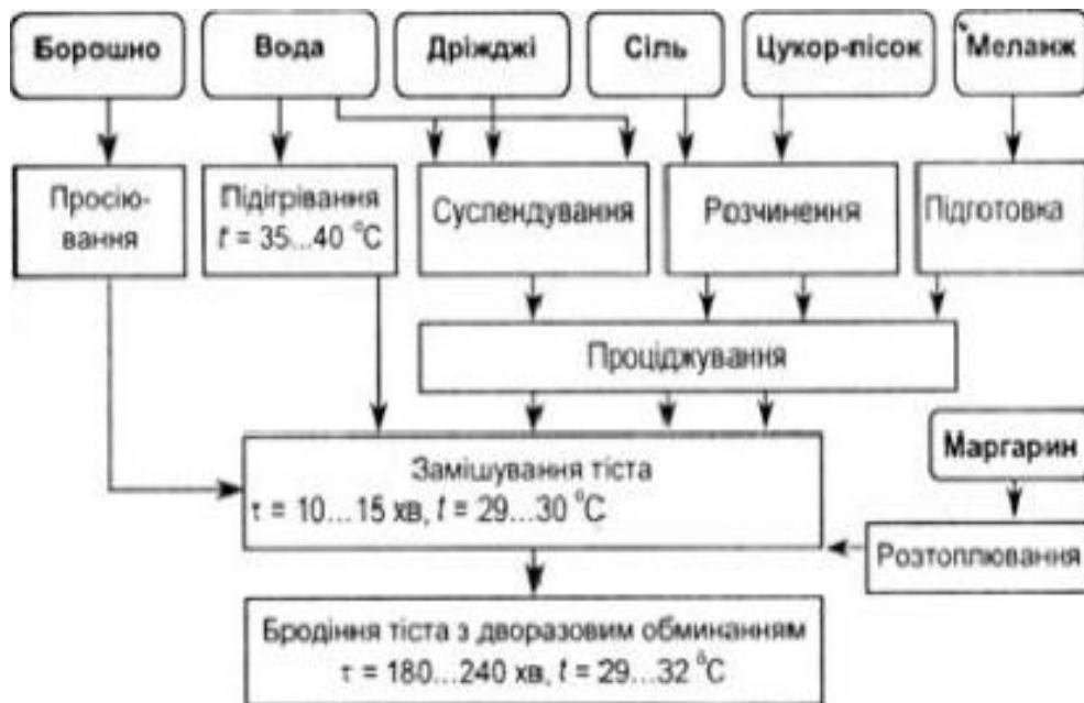
Схема 10. Технологічна схема приготування дріжджового безопарного тіста
